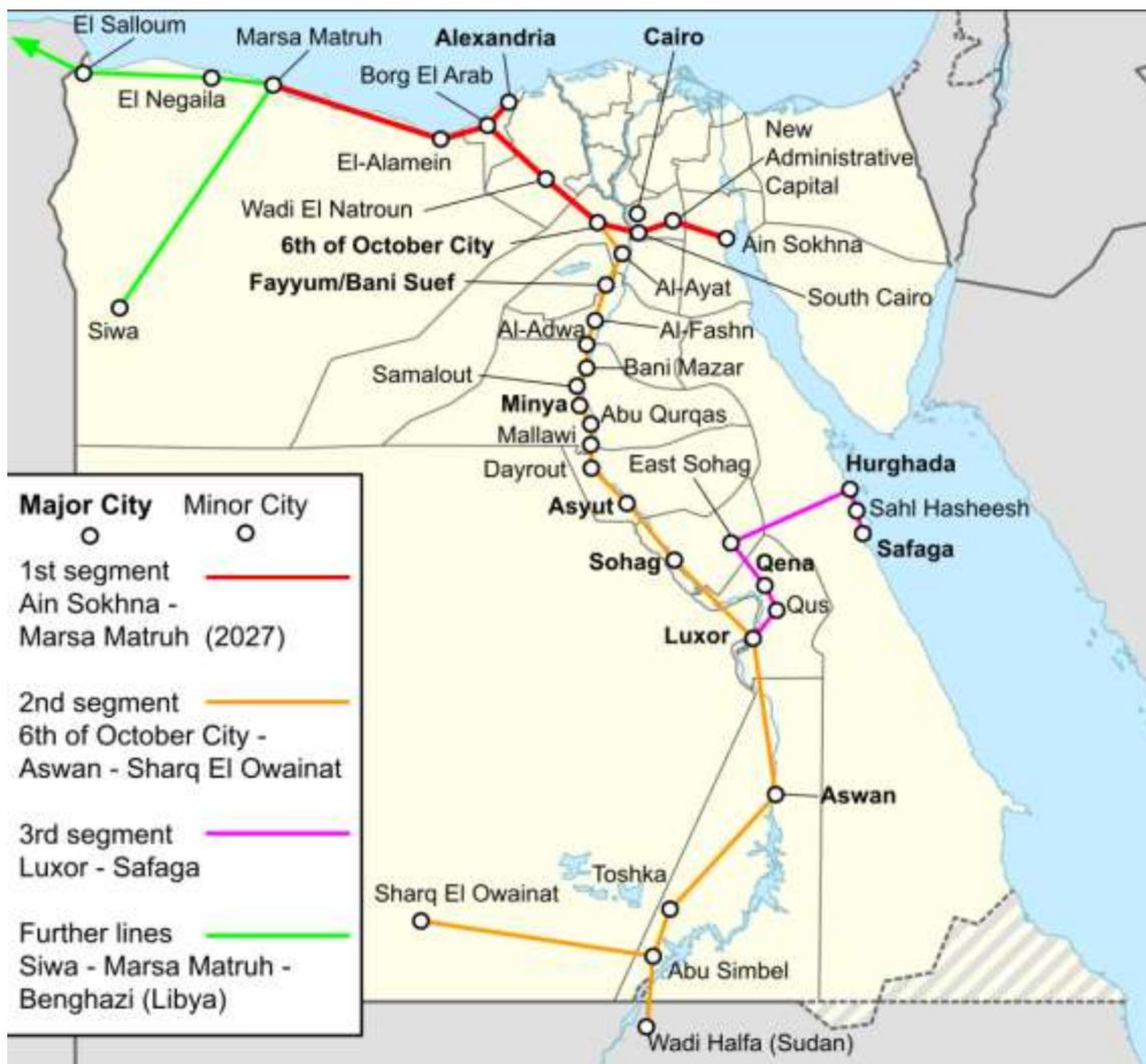
Figura 41 - Linee ferroviarie ad alta velocità pianificate in Egitto <sup>124</sup> (maggio 2022)
