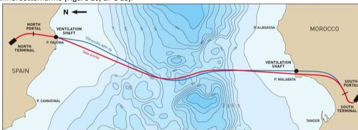
Figura 16 - Ipotesi di tracciato del tunnel sottomarino di Gibilterra<sup>60</sup>
