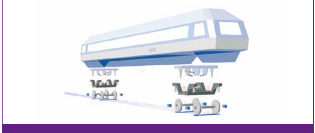
Figura 5 . Costruzione del modello di veicolo completo in ambiente Simpack
