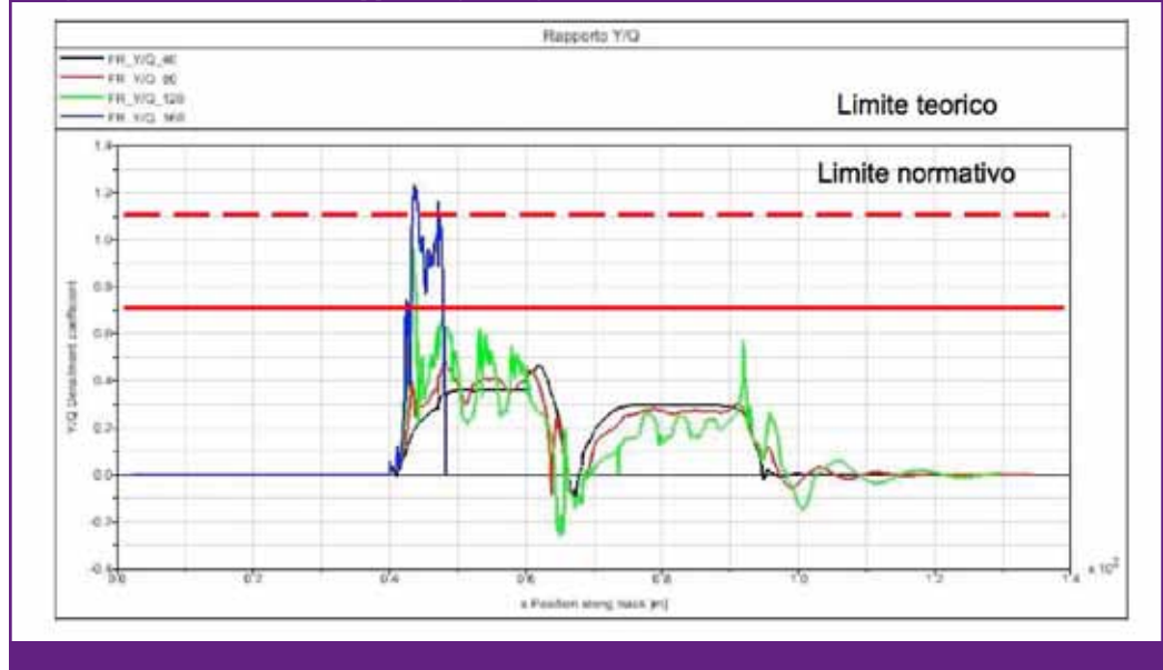
Figura 7 . Andamento del rapporto Y/Q lungo il tracciato, al variare della velocità
